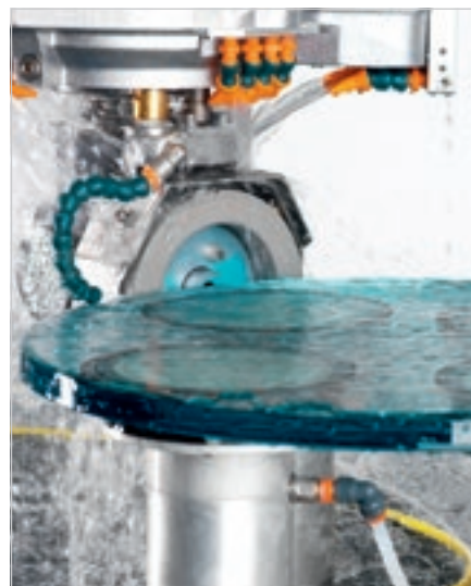
Amolado de taza con agregado.
