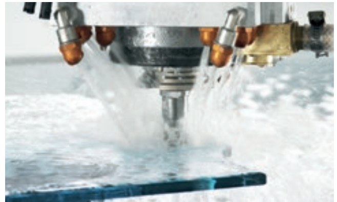
Perforación desde arriba.
