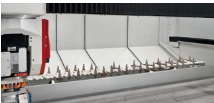
Almacén trasero de dos filas.
