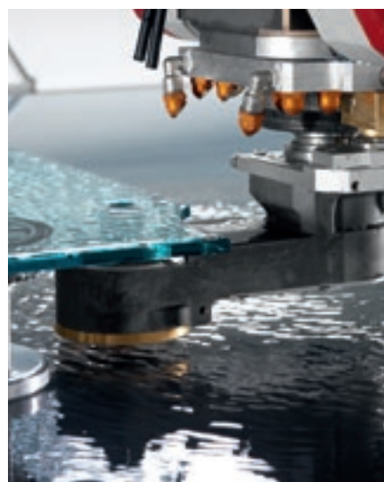
Perforación desde abajo.
