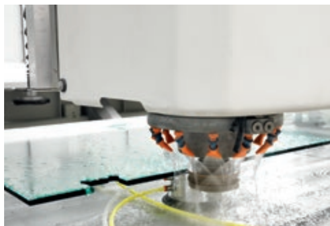
Amolado del canto periférico brillante.
